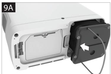
10. Empuje para introducir la columna en el dispositivo, de modo que quede completamente asentada en el concentrador OxyGo NEXT. El botón del seguro con resorte debe regresar por completo a la posición cerrada.
