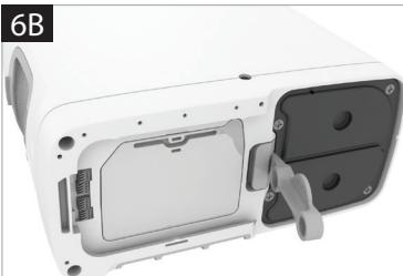
7. A. Retire las columnas del OxyGo NEXT por completo. Se retiran ambas en una sola pieza, o
